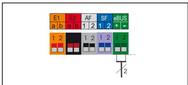
Рисунок: Подсоединение цифрового дополнительного регулирующего оборудования WOLF (интерфейс eBus)
