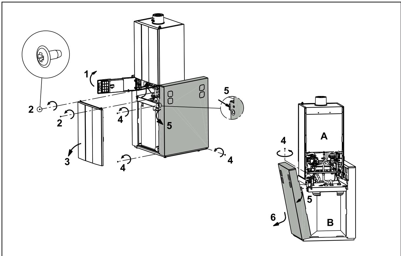
Рисунок: Демонтаж боковой обшивки водонагревателя CGS-2L/R
