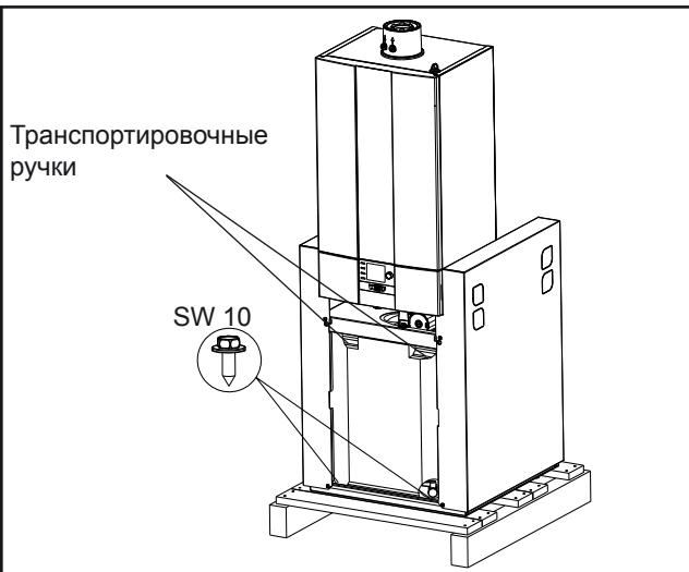
Рисунок: Транспортировочные ручки / крепежные винты спереди
