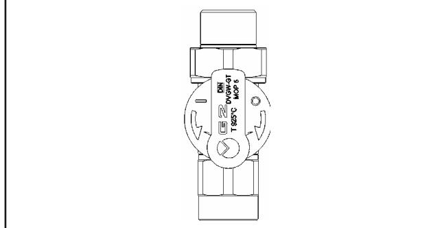
Рисунок: Газовый шаровой кран, прямой (доп. оборудование)
