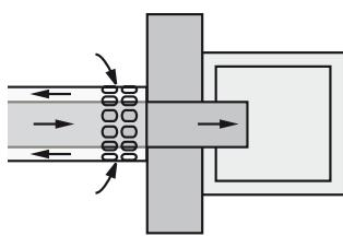
Подсоединение к дымовой трубе с отверстиями для воздуха должно устанавливаться непосредственно на дымовой трубе согласно рисунку чтобы все части системы отвода ОГ обдувались воздухом для горения.
