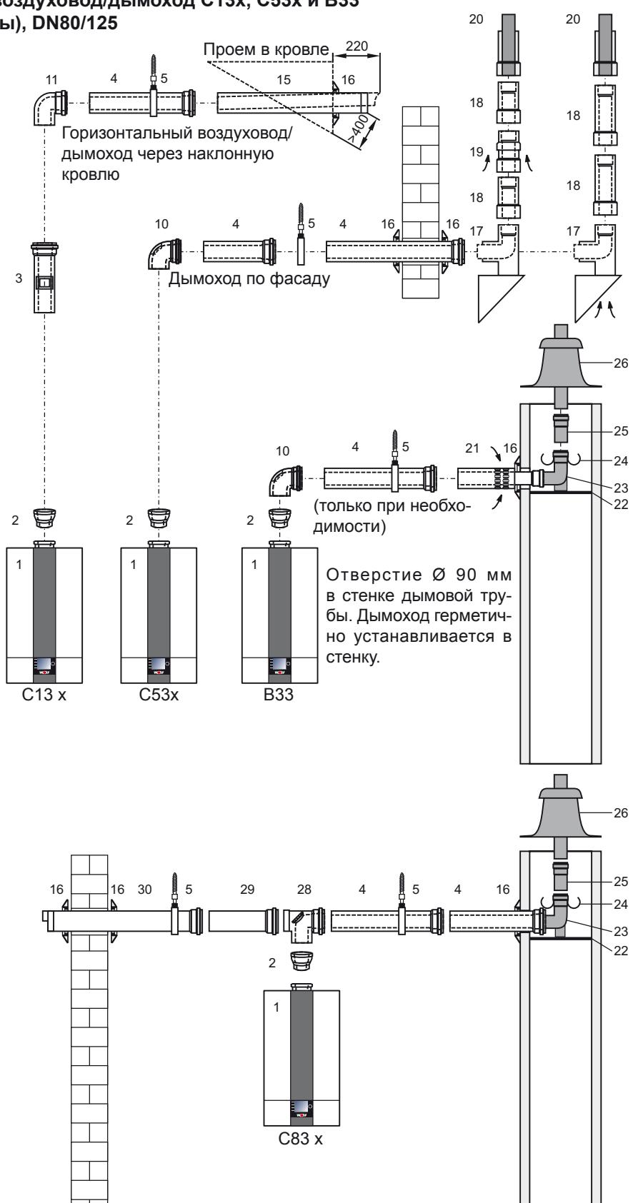
Горизонтальный дымоход монтируется с уклоном около 3° (6 см/м) к установке. Горизонтальный воздуховод прокладывается с уклоном около 3° наружу. Место всасывания воздуха следует защитить от ветра. Допустимое давление ветра на входе воздуха 90 Па, так как при большем давлении ветра работа горелки невозможна. В шахте после опорного колена (23) можно установить дымоход DN80. Гибкий дымоход DN83 можно подсоединить после опорного колена (23).
