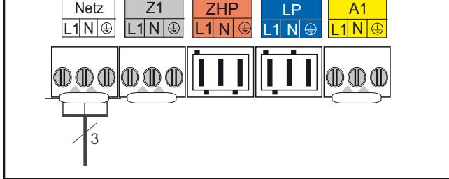
Рисунок: Подсоединение к электрической сети
