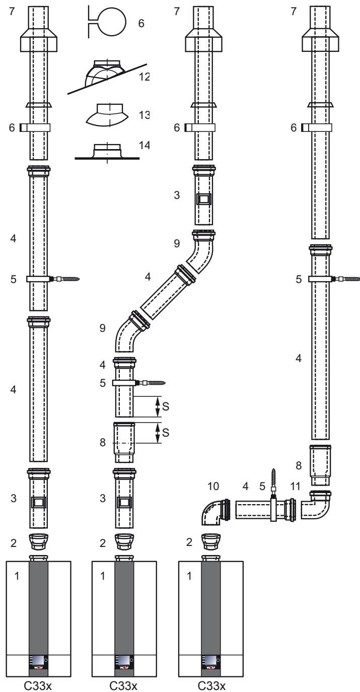
**Вид C33x:** Газовый конденсационный котел с подводом воздуха для горения и отводом ОГ вертикально через кровлю.
