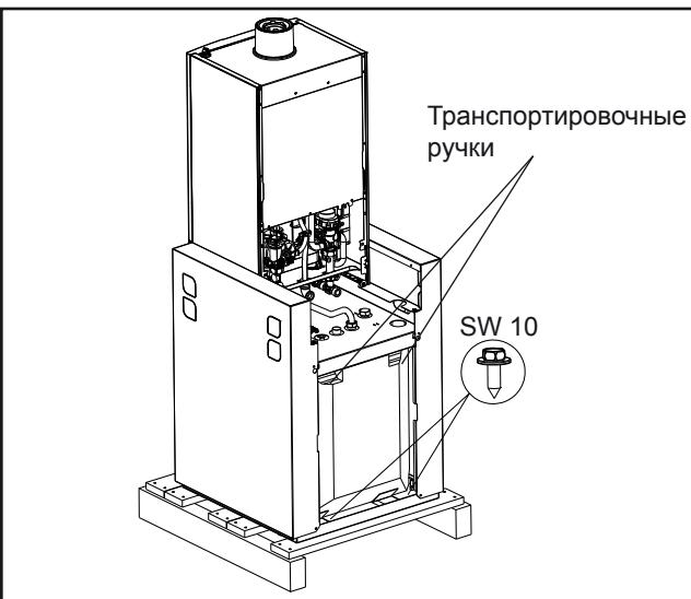
Рисунок: Транспортировочные ручки / крепежные винты сзади
