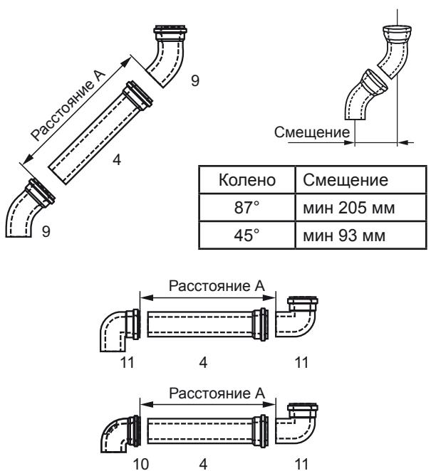
Определить расстояние А. Длина воздуховода/дымохода (4) всегда приблизительно на 100 mm больше расстояния А. Дымоход всегда укорачивается на гладкой стороне, а **не** на стороне муфты. После укорачивания снять фаску с трубы ОГ напильником.
