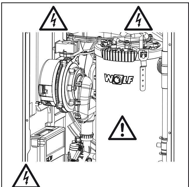
Рисунок: Запальний трансформатор, высоковольтный запальный электрод, камера сгорания
