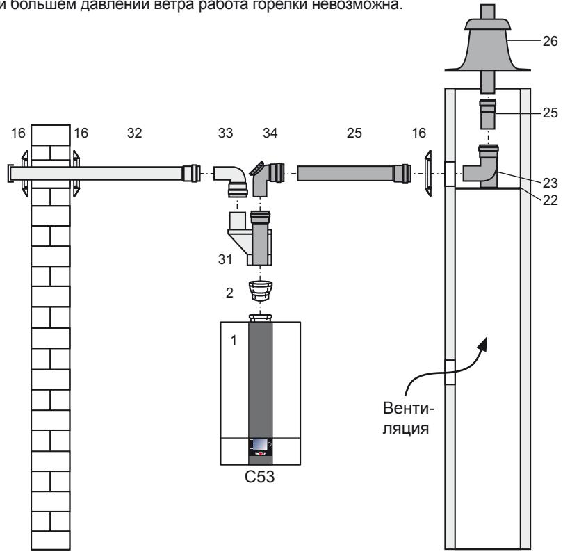
Между дымоходом и внутренней стенкой шахты необходимо соблюдать следующее расстояние в свету: при круглой шахте: 3 см
