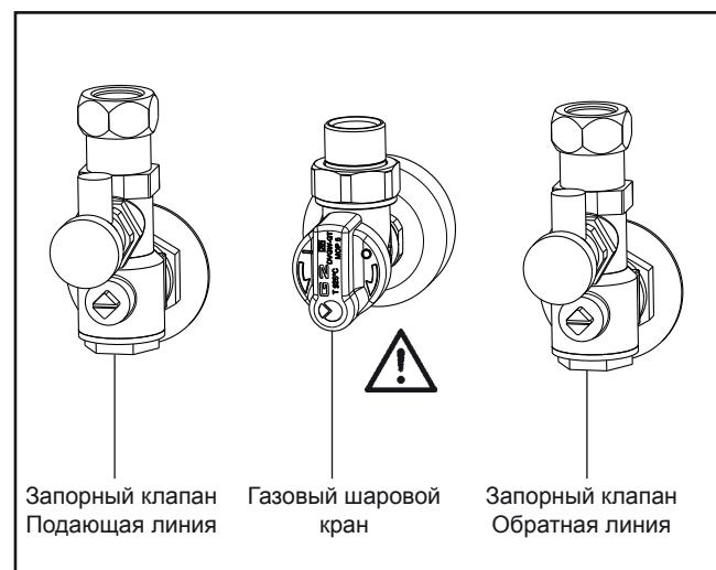
Рисунок: Подвод газа: опасность отравления и взрыва из-за утечки газа
