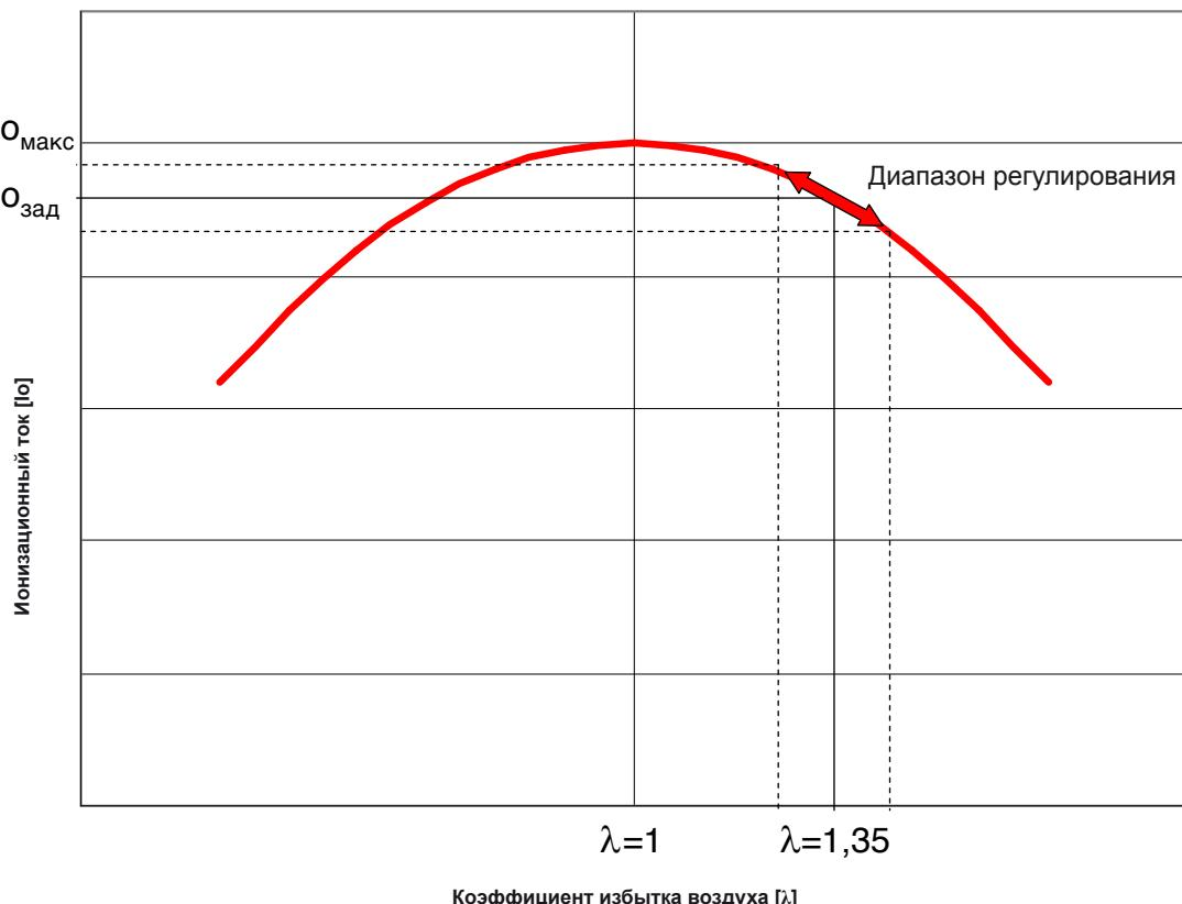
Рисунок: Диаграмма регулирования ионизационного тока
