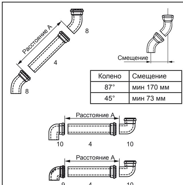
Определить расстояние А. Длина воздуховода/дымохода (4) всегда приблизительно на 100 мм больше расстояния А. Дымоход всегда укорачивается на гладкой стороне, а **не** на стороне муфты. После укорачивания снять фаску с трубы ОГ напильником.
