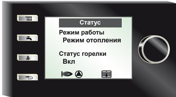
АМ служит исключительно модулем индикации для теплогенератора. Возможна настройка и отображение специфических параметров и значений теплогенератора.
