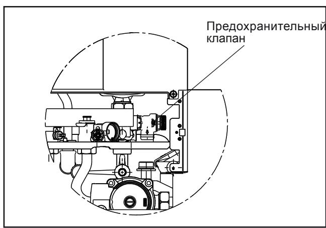
Рисунок: Предохранительный клапан контура отопления (представлено для CGS-2L)
