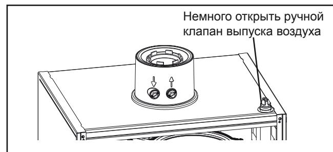
Рисунок: Ручной клапан выпуска воздуха
