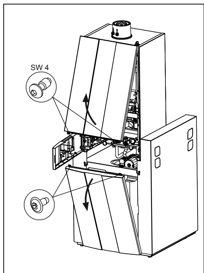
Рисунок: Демонтаж передней обшивки водонагревателя по слойного нагрева
