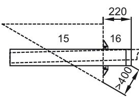
При монтаже переместить разъединительное устройство (8) до упора в муфту. Следующий воздуховод/дымоход (4) задвинуть на 50 mm (размер «S») в муфту разъединительного устройства и обязательно закрепить в этом положении, например, трубным хомутом DN125 (5) или стопорным винтом со стороны воздуховода.
