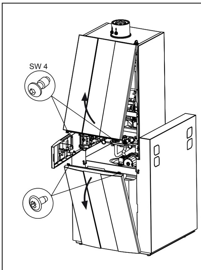
Рисунок: Демонтаж передней обшивки водонагревателя по-слойного нагрева
