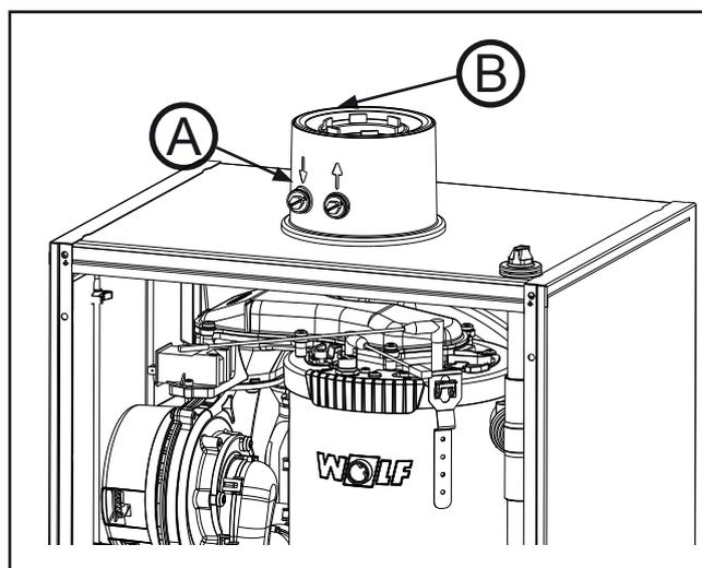
Рисунок: Измерение параметров отработавших газов
