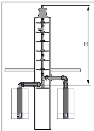
Рисунок: Многокотельная схема
