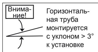
Горизонтальный воздуховод/дымоход/подсоединение к LAS (примеры), система DN60/100
