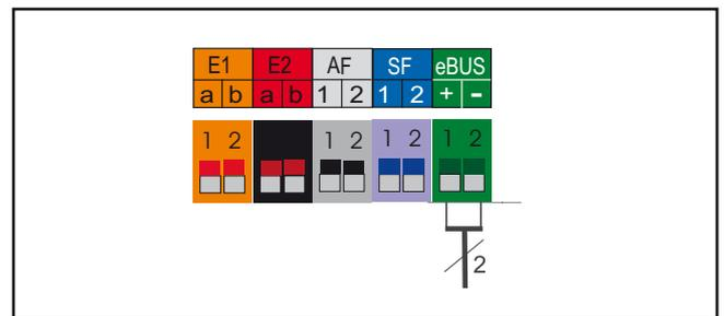
Рисунок: Подсоединение цифрового дополнительного регулирующего устройства WOLF (интерфейс eBus)
