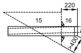
При монтаже переместить разъединительное устройство (8) до упора в муфту. Следующий воздуховод/дымоход (4) задвинуть на 50 мм (размер «S») в муфту разъединительного устройства и обязательно закрепить в этом положении, например, трубным хомутом DN125 (5) или стопорным винтом со стороны воздуховода.
