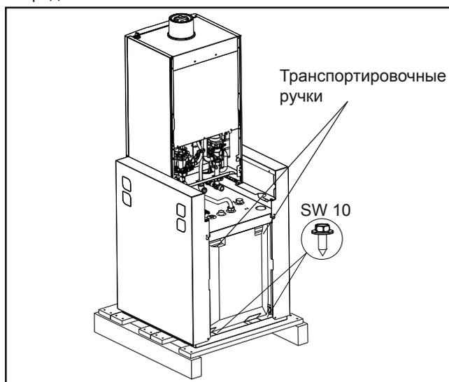
Рисунок: Транспортировочные ручки / крепежные винты сзади
