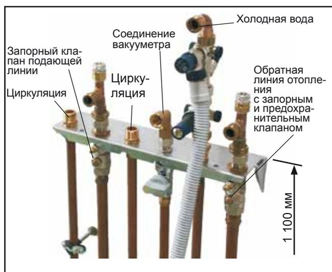
Рисунок: Подсоединение к консоли для открытого монтажа (дополнительное оборудование)
