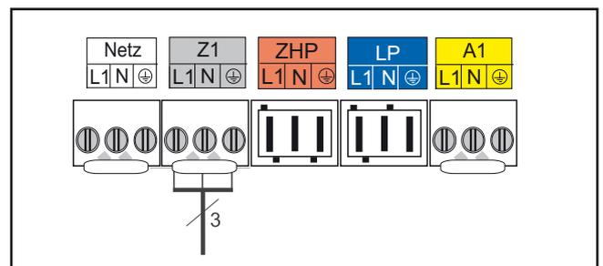
Рисунок: Подсоединение выхода Z1
