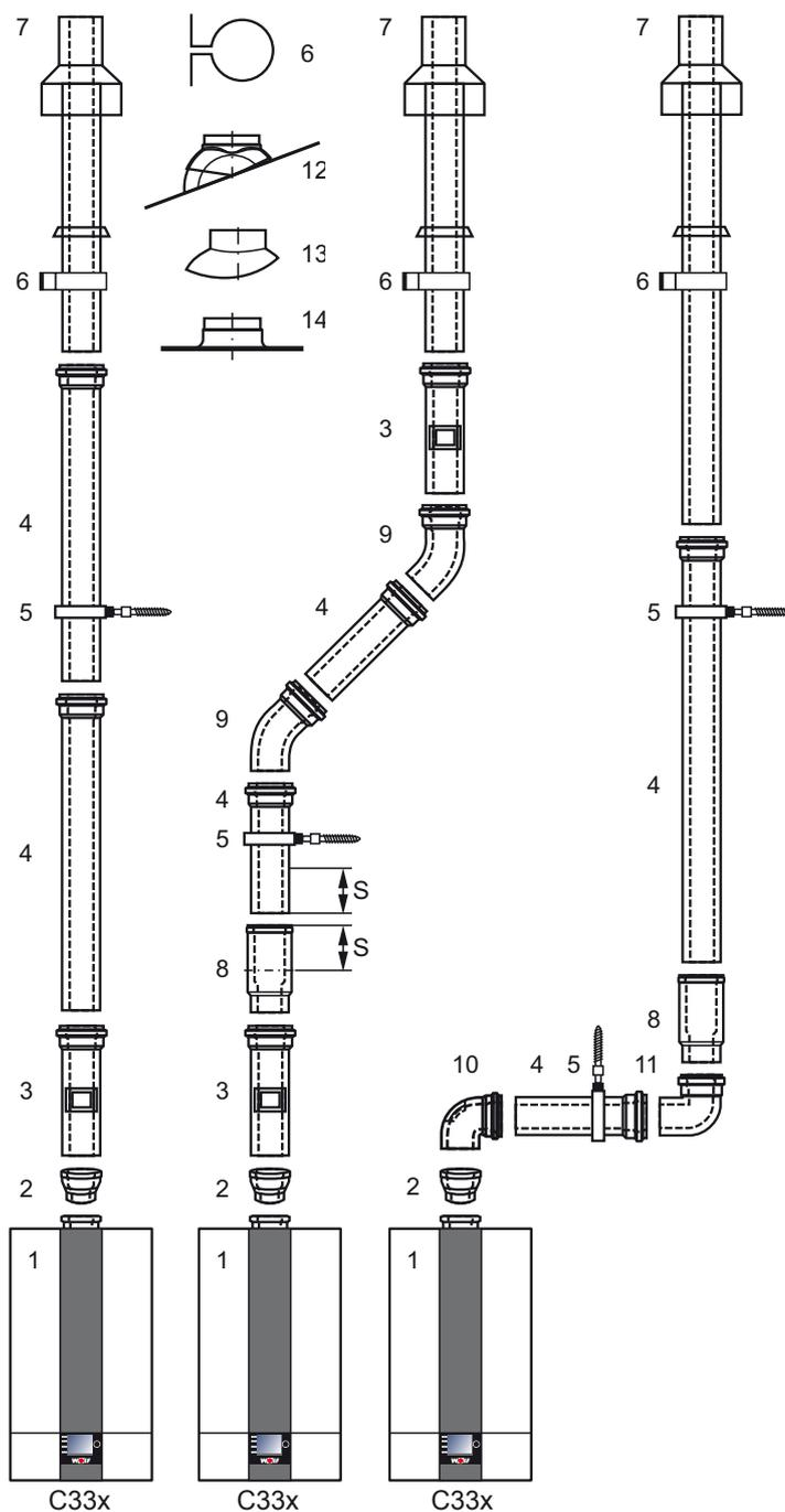
**Вид С33х:** Газовый конденсационный котел с подводом воздуха для горения и отводом ОГ вертикально через кровлю.
