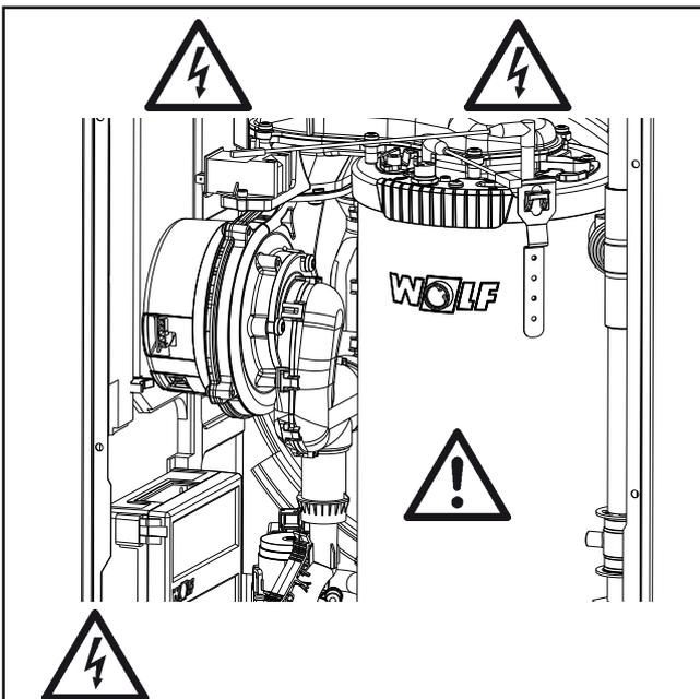
Рисунок: Запальный трансформатор, высоковольтный запальный электрод, камера сгорания
