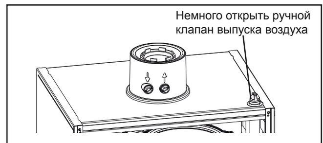
Рисунок: Ручной клапан выпуска воздуха
