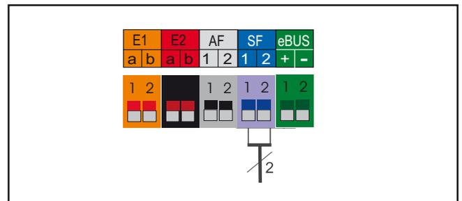
Рисунок: Подсоединение датчика бака-накопителя
