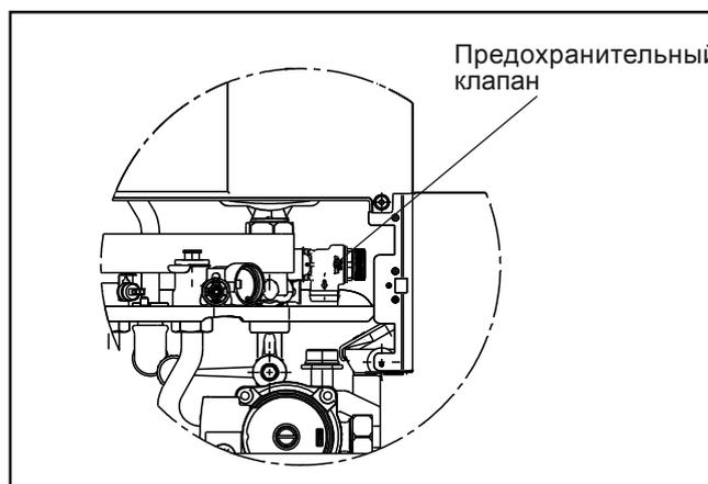
Рисунок: Предохранительный клапан контура отопления (представлено для CGS-2L)
