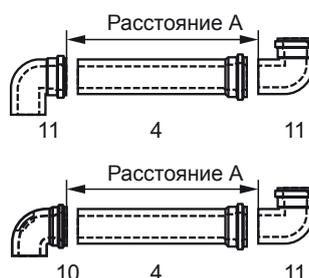
Определить расстояние А. Длина воздуховода/дымохода (4) всегда приблизительно на 100 мм больше расстояния А. Дымоход всегда укорачивается на гладкой стороне, а **не** на стороне муфты. **После укорачивания снять фаску с трубы ОГ напильником.**
