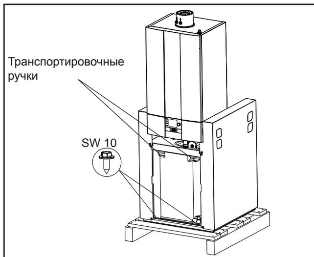
Рисунок: Транспортировочные ручки / крепежные винты спереди
