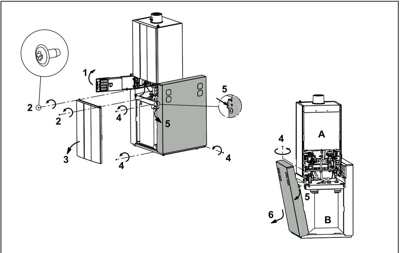
Рисунок: Демонтаж боковой обшивки водонагревателя CGS-2L/R
