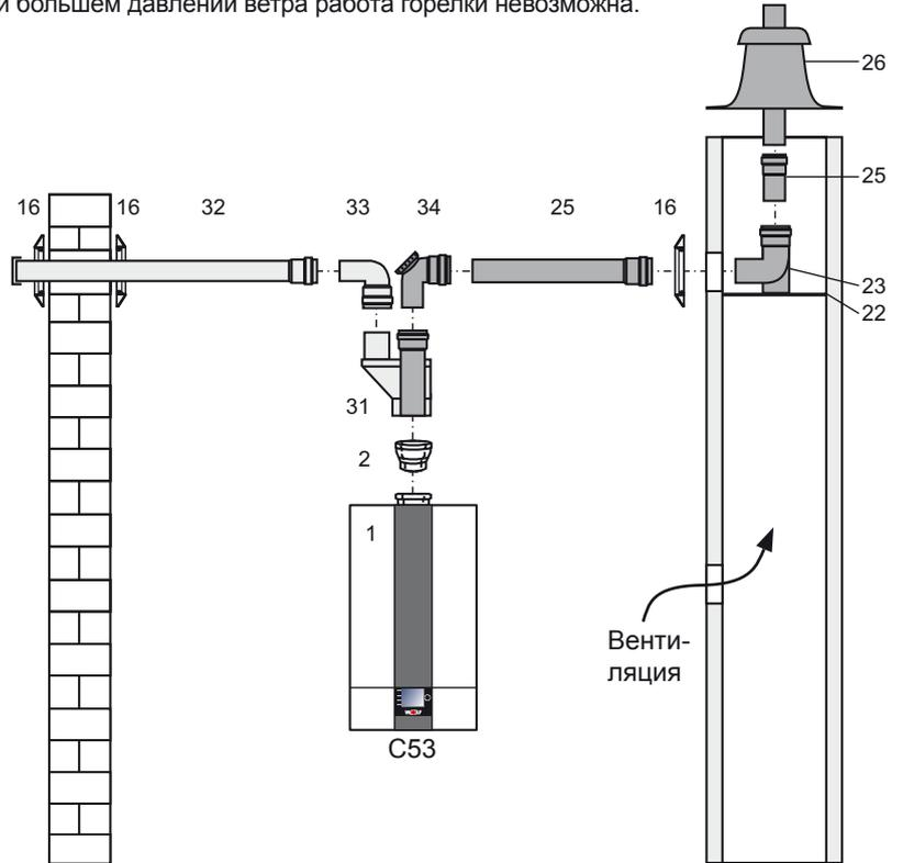
Между дымоходом и внутренней стенкой шахты необходимо соблюдать следующее расстояние в свету: при круглой шахте: 3 см
