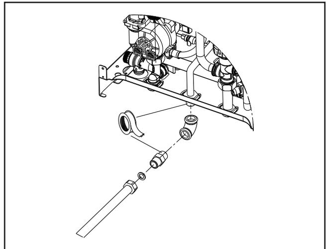
Рисунок: Монтаж подвода газа
