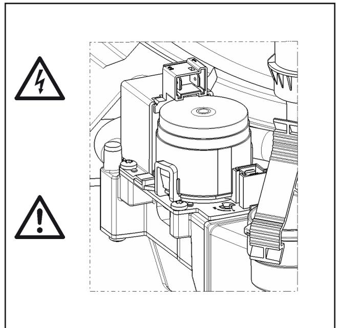
Рисунок: Комбинированный газовый клапан
